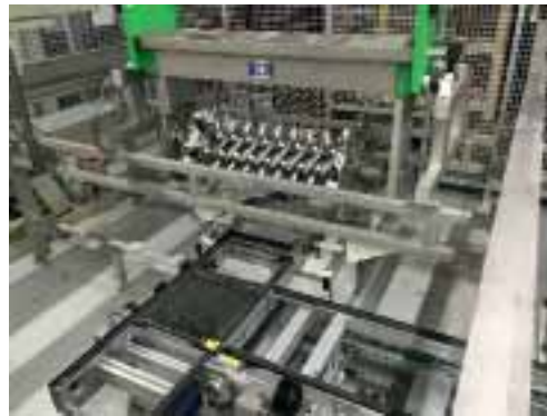
Abb. 2: Vollautomatische Be- und Entladeposition mit Förderbändern
